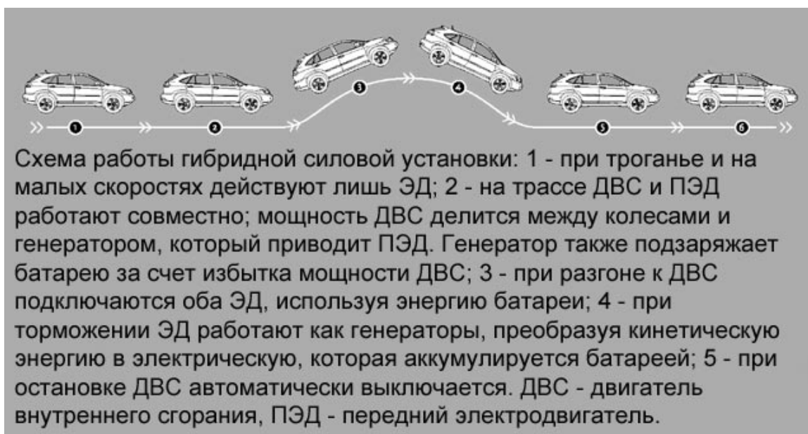
Рис.13. Работа ГСУ автомобиля Lexus RX400h
