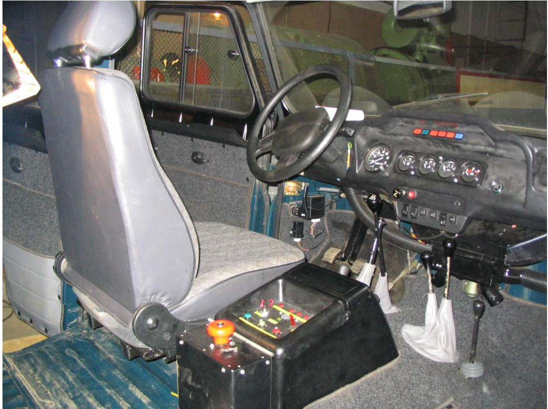
Рис. 42. Размещение пульта управления и блока управления режимами электромашины
